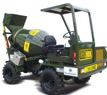
**УСИЛЕННОЕ ШАССИ:** 3х-цилиндровый дизельный двигатель фирмы CUMMINS. 37 л. с., водяное охлаждение, привод на 4 колеса, дисковые тормоза, парковочный тормоз, гидростатическая трансмиссия, питание напряжением в 12 в для стартера, освещения, обслуживания. Открытая кабина и вращающееся кресло для водителя; органы управления гидравликой поворачиваются вместе с креслом. Аккумулятор с системой аварийного отключения.
