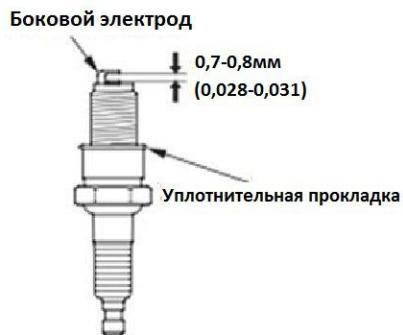
Рекомендуемая свеча зажигания имеет правильный диапазон нагрева для двигателя.
