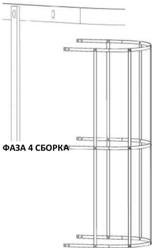
Установите кронштейны № 5 на шарниры № 3, прикрутив в предварительно просверленные отверстия № 15 (деталь G) с помощью болтов M10 X 40. Вставьте болты изнутри наружу. (См. Таблицу оборудования)
