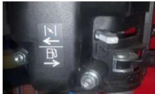
Чтобы запустить остывший двигатель, переведите рычаг воздушной заслонки или штангу воздушной заслонки (соответствующих типов) в ЗАКРЫТОЕ положение.
